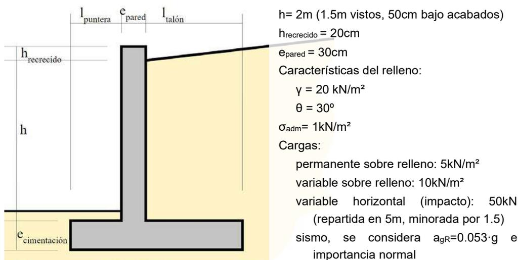
Ilustración 18: Geometría y cargas a analizar en los muros de contención
