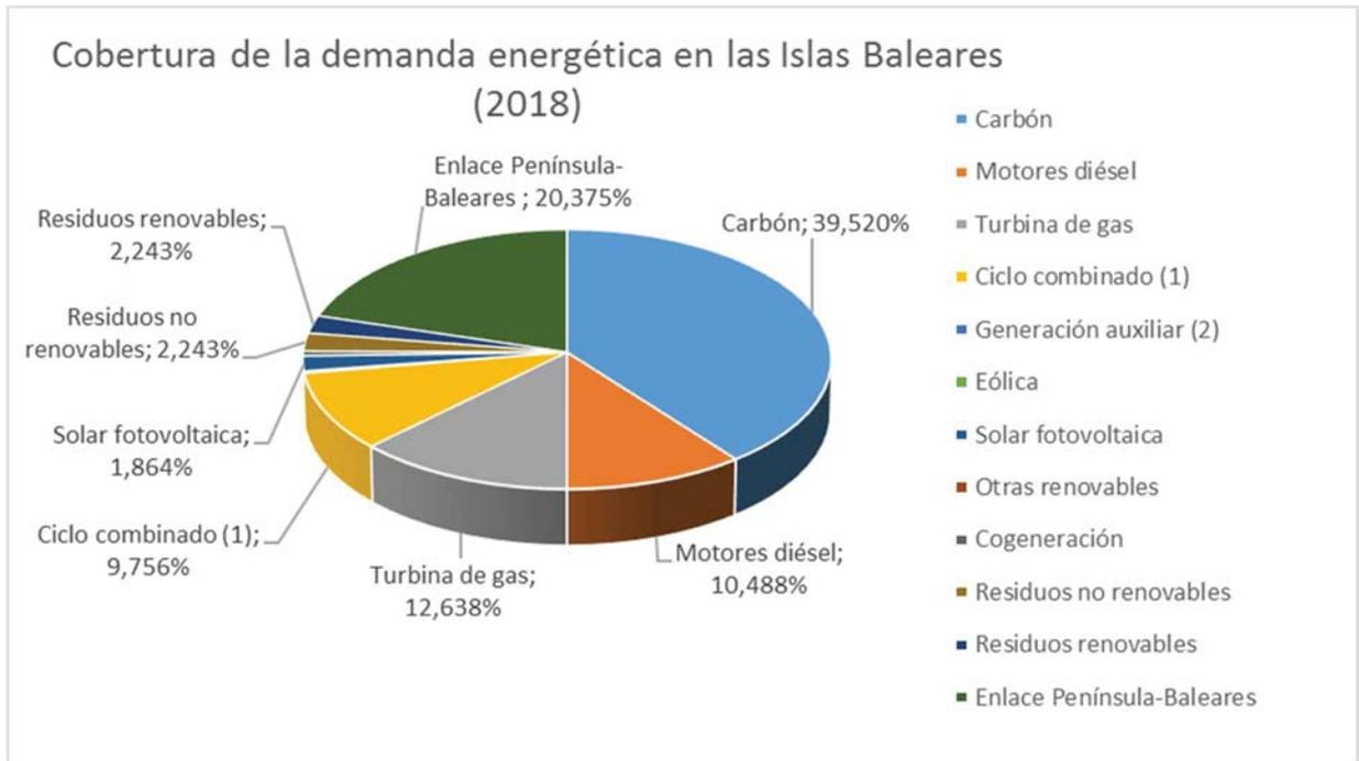
*Figura 2. Diagrama de cobertura de la demanda eléctrica en las Islas Baleares. Fuente: REE. Elaboración por parte de Tecnoambiente*
