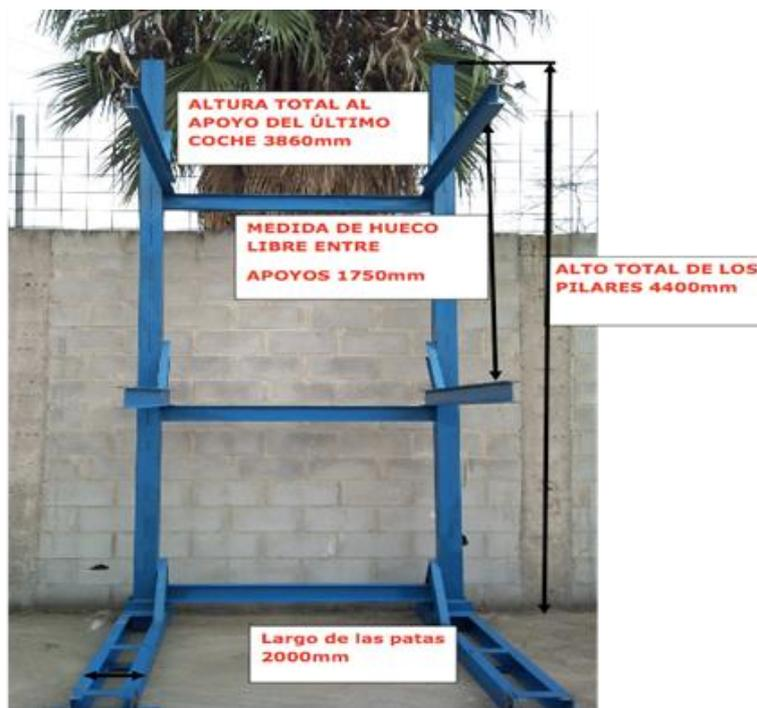
*Ilustración 6. -Esteria de almacenamiento de VFU de 3 alturas.*
