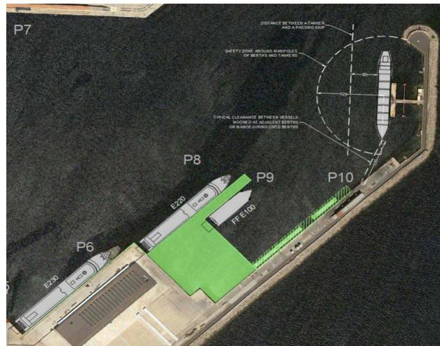
Fig. 5.- Alternativa D de ubicación (seleccionada) en la 2ª alineación del Dique del Oeste. Fuente: documento de inicio.
