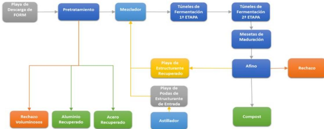
Ilustración 5.1- Diagrama de flujo de proceso (PFD) de la planta de tratamiento de biorresiduos
