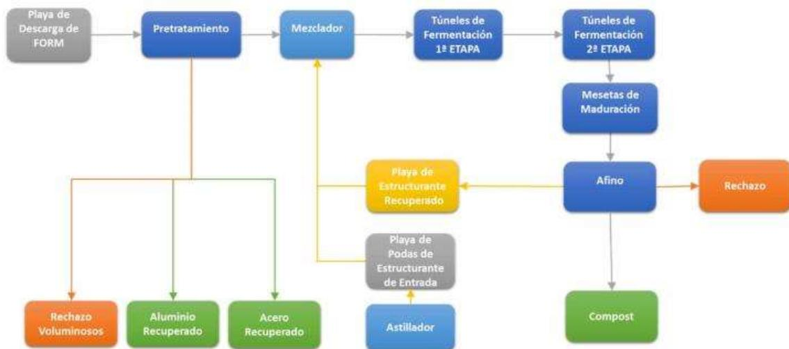
Ilustración 2.- Diagrama de bloques del proceso
