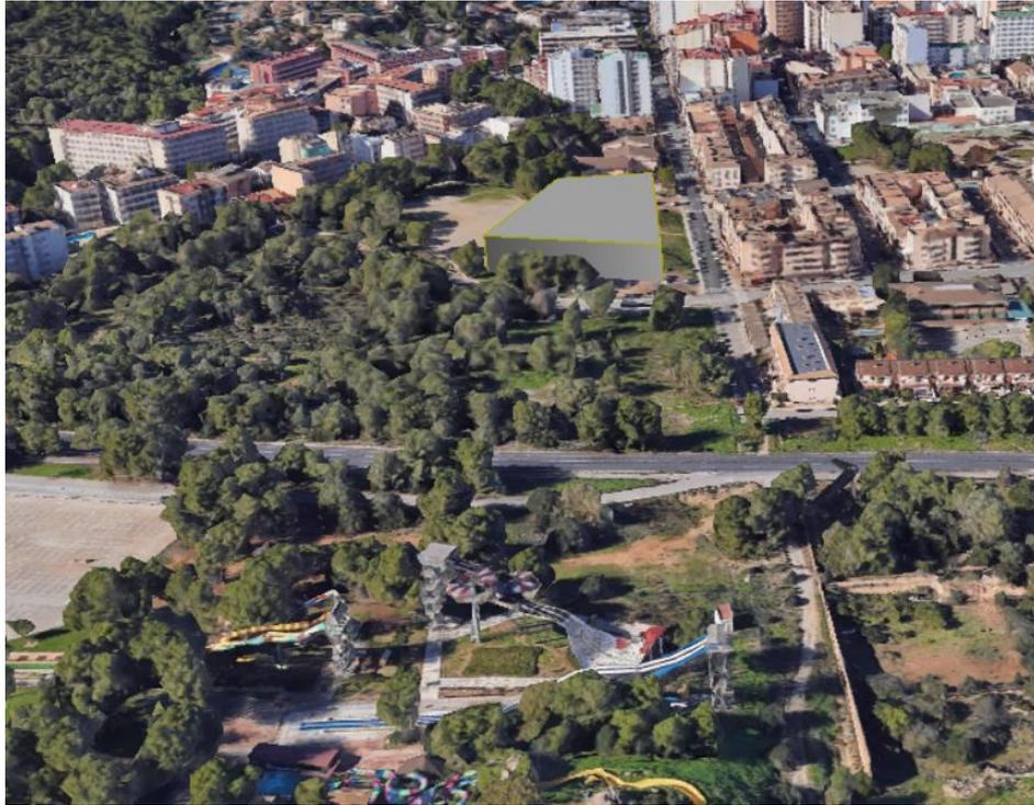
Imagen 19. Introducción en la imagen de un volumen edificado con una altura de 15 m dentro de la vista generada con Google Earth
