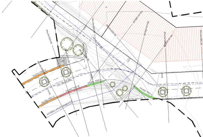
Ilustración 2 Estructuras de contención y pasadizos de conexión entre parques
