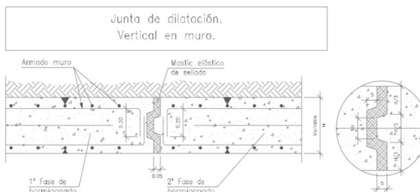
Ilustración 6 Detalle junta de dilatación
