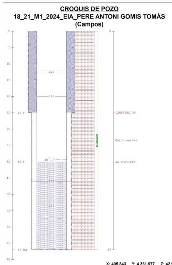
Figura 8: corte estratigráfico
