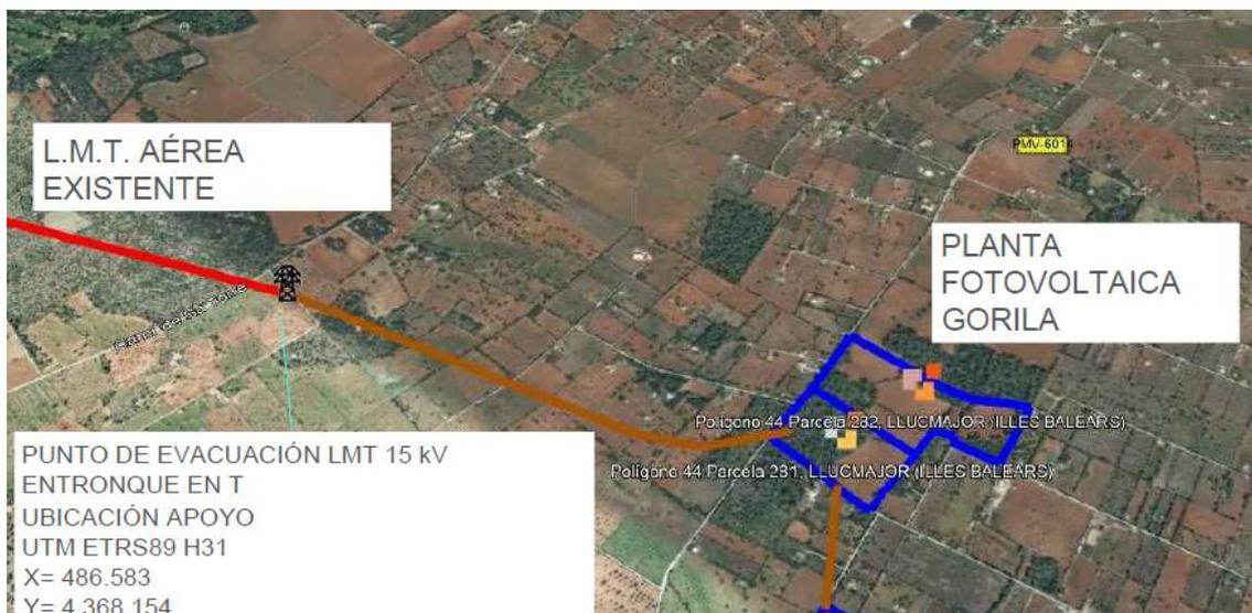
**Imagen.** Disposición del punto de conexión con línea eléctrica existente
