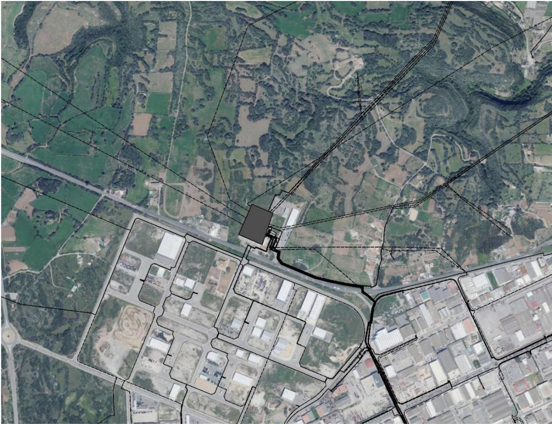
**Figura 1.** *Ejemplo de sistema radial de la red de distribución eléctrica.*
