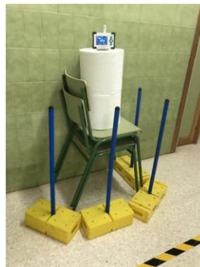
Una vez elegido el punto de medida, es conveniente colocar el medidor de CO<sub>2</sub> en dicho punto con tiempo suficiente (al menos 10 minutos), para asegurar el tiempo de respuesta del medidor. El mismo punto seleccionado para la medida en el caso de querer hacer un estudio de los niveles de CO<sub>2</sub>, puede utilizarse para colocarlo si se quiere utilizar el medidor de CO<sub>2</sub> como pauta real de ventilación (apertura y cierre de ventanas).
